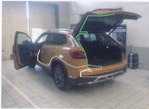
3. 1-es A csomagtartó ajtó pozitív kábele, az a kapcsoló kábele. A 2-es pedig az állandó 12V kábele. A 3-as a ACC (gyújtás) kábele. 4-es az a GND (föld)
