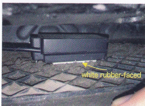
7. Keresse meg a becsavart csavarokat a lökhárító belső oldalán majd szerelje fel a szenzort úgy, hogy az a 3M ragasztóval lefelé álljon.
