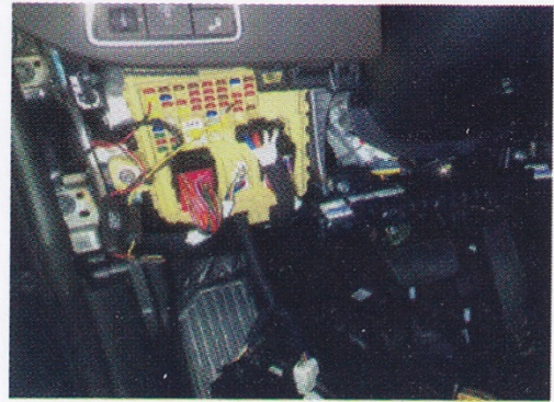
2. Tesztelje a CLP 12-öt és a gyújtás (ACC) kábelt egy fázisceruzával vagy multiméterrel. (Megjegyzés a CLP 12, teszt áram 12 V az autó beindítása nélkül a sárga kábelhez van csatlakoztatva. ACC (gyújtás) kábel: Amikor elindítja a gépjárművet csak akkor mérhető rajta feszültség, amikor leállítja a feszültség 0 lesz, ez lesz a gyújtás (ACC) kábel.
